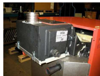
Condenseur à eau à l'arrière d'une chaudière à bûches (prototype)
