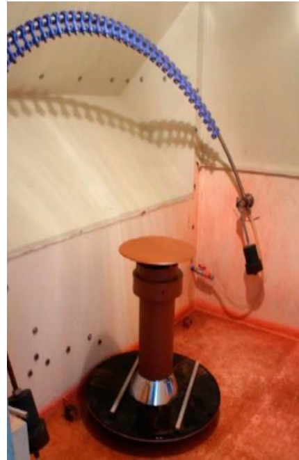
Vue du chapeau de la sortie de toit VENTÉLIA lors des essais au laboratoire CERIC
